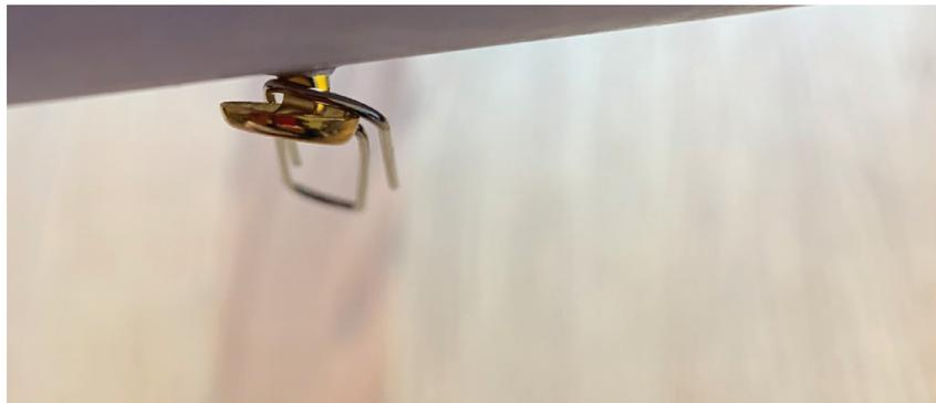
*Figura 2.4: Si el sujetapapeles está demasiado apretado, el clip no girará.*
