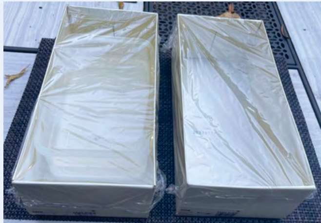
그림 4.2: 열 흡수체 모델 설정. 왼쪽의 상자에는 물이 담긴 용기가 있으며 오른쪽 상자에는 없음
