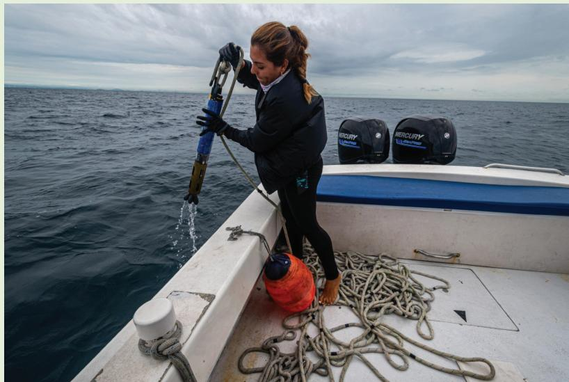
*Figura 14: Alexandra Guzman utiliza una sonda de agua para recolectar datos.*
