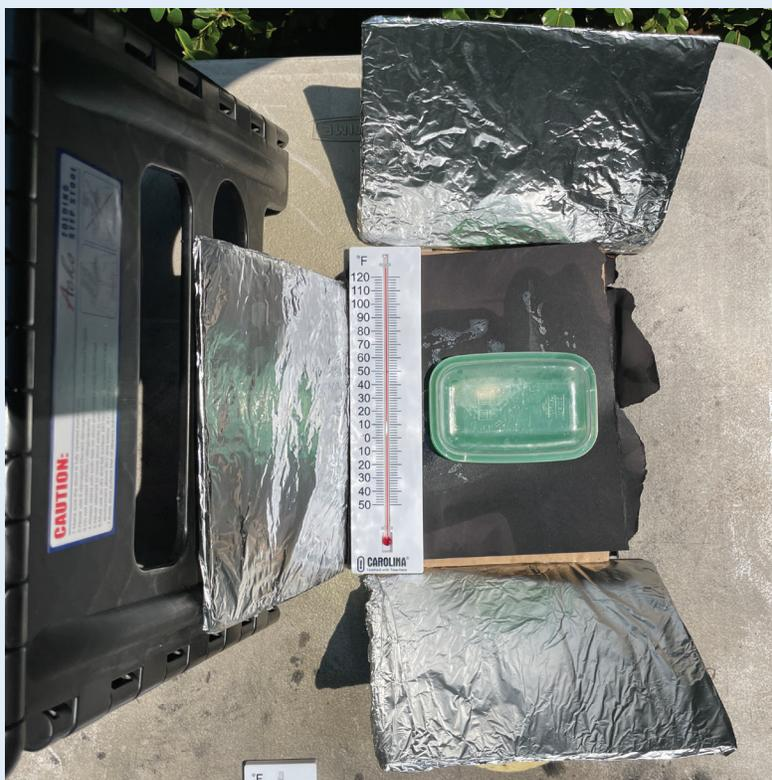
*Figura 3.9: Una estufa solar sencilla. Esta estufa tiene tres caras reflectantes. Tu modelo tendrá cuatro caras reflectantes.*
